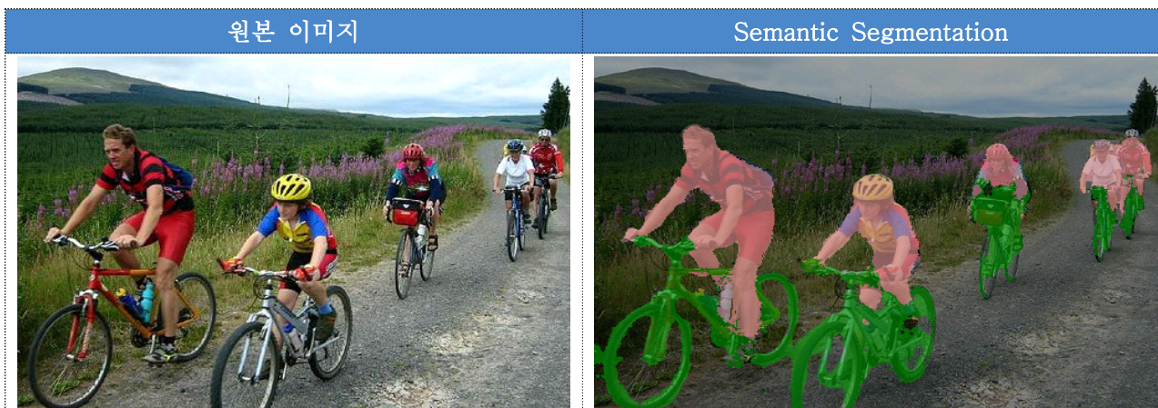
< 그림 Ⅲ-21 > RNN(Recurrent Neural Network)를 활용한 semantic image segmentation의 예
